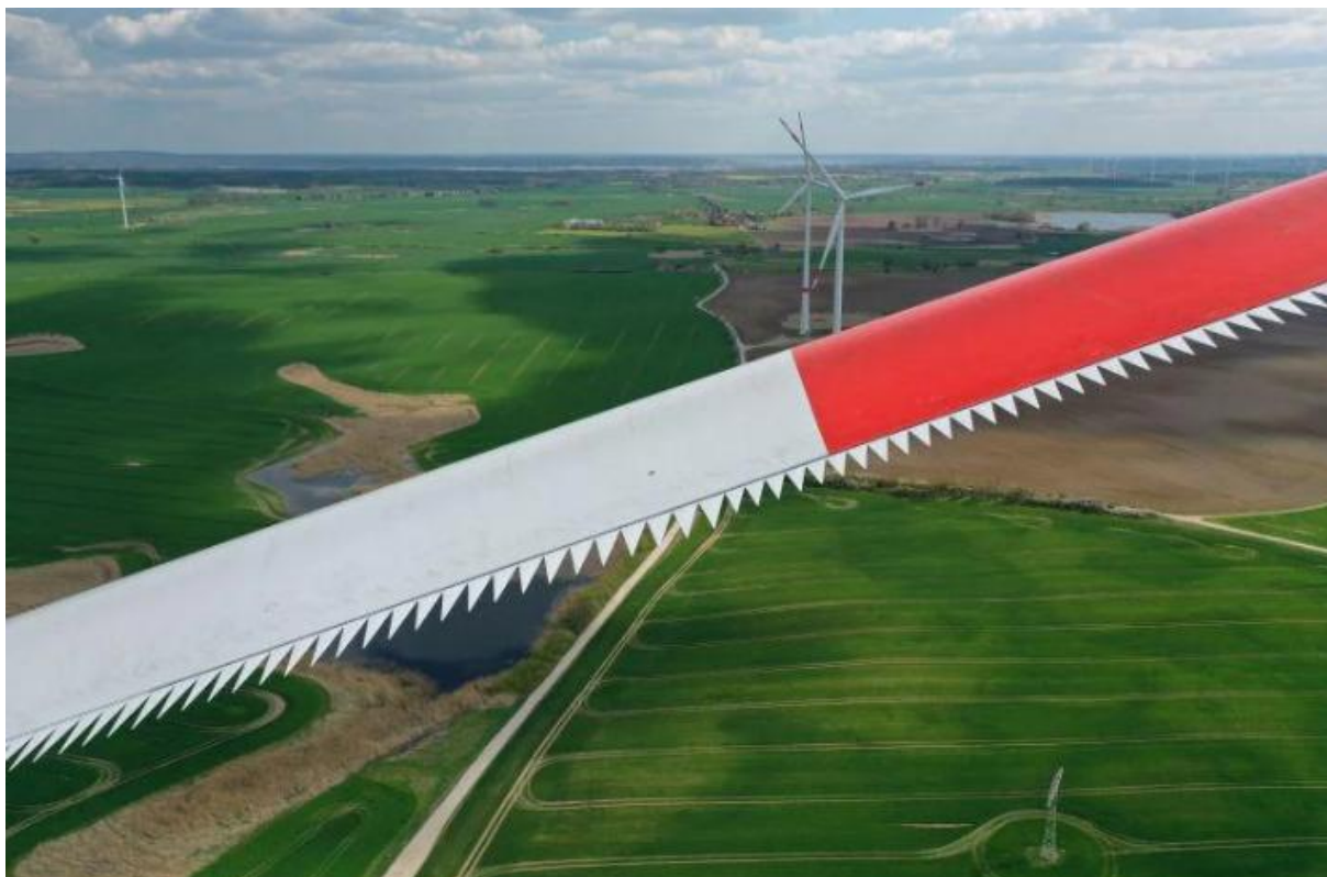
Obr. 13 Vroubkovaná odtoková hrana na VTE – příklad instalace (zdroj: https://www.windsourcing.com )
